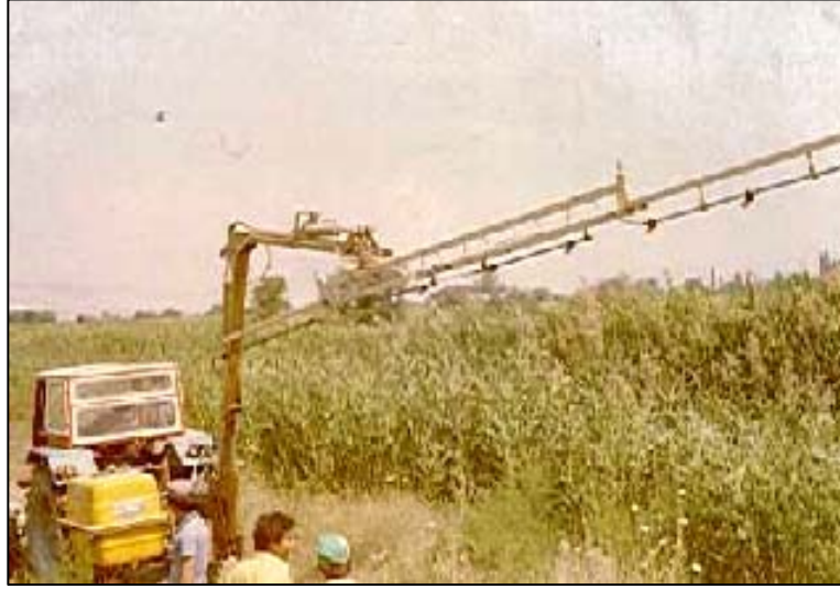
Şekil 7.10.Boşaltma Kanallarında, Halat Yöntemi ile Uygulama Yapılması
