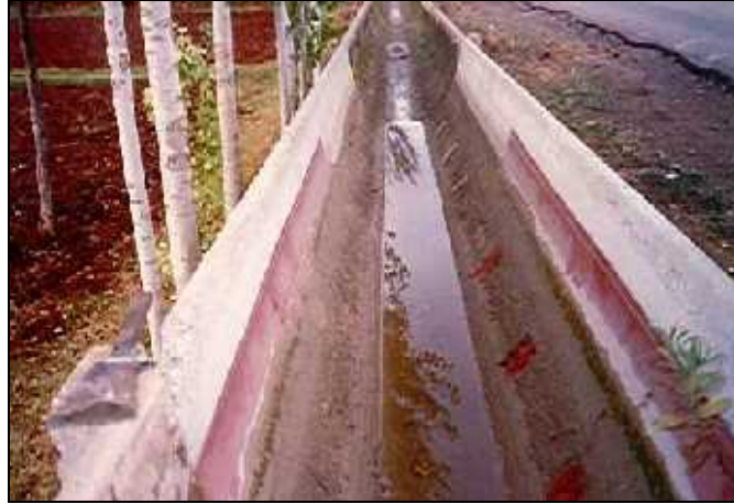
Şekil 7.25.Tutunmayı Önleyici Boyalarla Kanaletlerde Yapılan Denemeler
