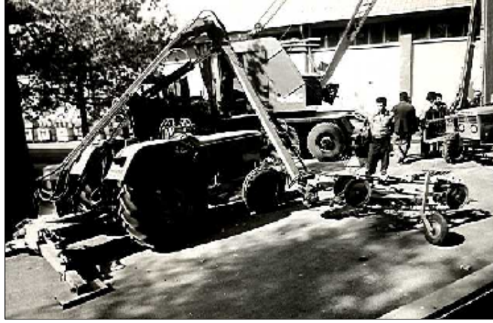
Şekil 5.15. Biçme Kollu Yabancı Ot Tırnığı Takılmış Hidrolik Kollu İş Makinesi
