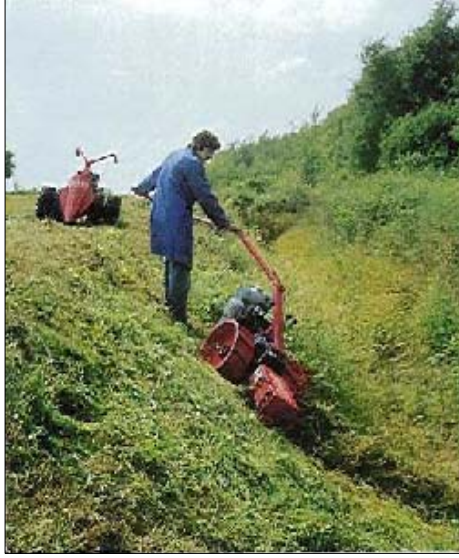
Şekil 5.21. Yamaçlarda Yayalarca Çalıştırılan Biçme Makinesi
