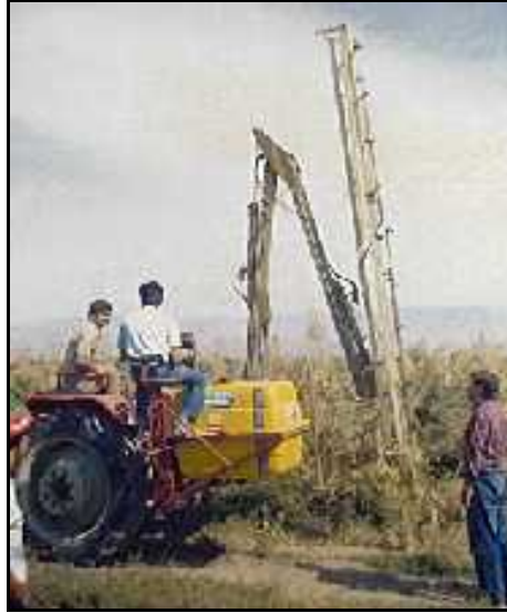
Şekil 8.3.Traktör Kuyruk Milinden Hareket Alan Bir Püskürtücü
