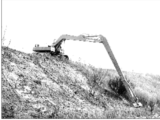
Şekil 5.16. Erişim Uzaklığı 16 m Olan ve Yabancı Ot Bıçme Kepçesi Takılabilen Hidrolikli İş Makinesi
