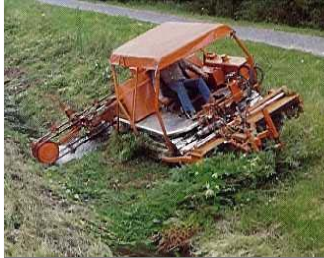
Şekil 5. 22. Değişik Eğimli Yamaçlarda Çalışabilen Biçme Makinesi
