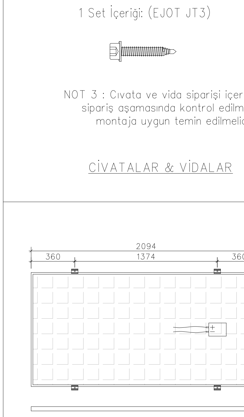
GÜNEŞ PANELİ DETAY Ölçü : 2094x1038x35 mm
